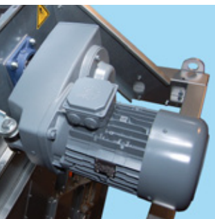
Напрямую смонтированный мотор-редуктор с опорной рамой.
